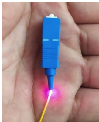
Imagen 19. Daño en pigtail
