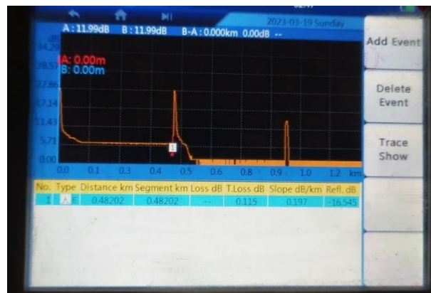
Imagen 16. Medición de OTDR con corte a 482 metros
