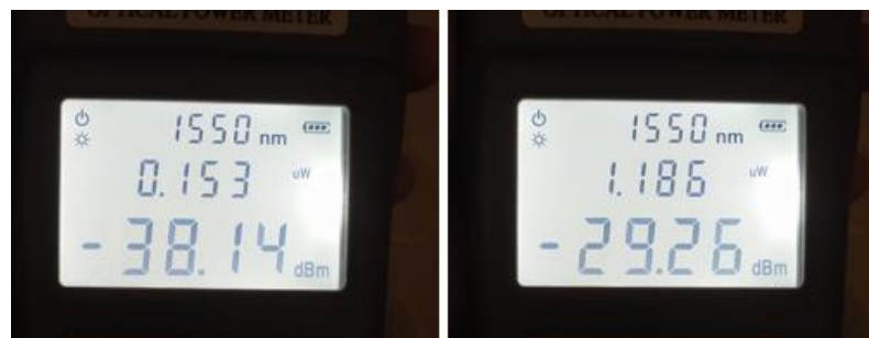
Imagen 21. Medición de atenuación
