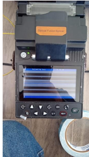
Imagen 16. Fusión con pérdidas de 001 dBm.
