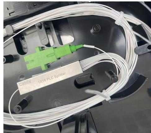
Una vez organizado el divisor óptico, coloque el pigtail de alimentación a fusionarse, mida en la parte trasera el tamaño a usar y corte el excedente del pigtail.
