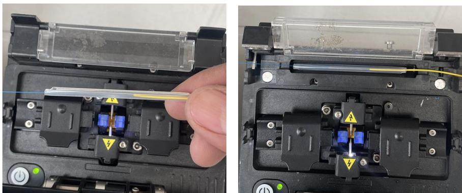
Al tener adherido el tubo a la fibra óptica, organice el cableado en la bandeja posterior.
