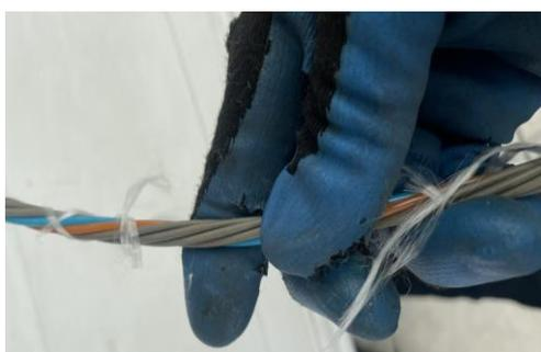
Una vez retirado el material de protección, se debe apreciar tres elementos principales como se aprecia en la imagen: elemento de tensión, par trenzado y buffer.
