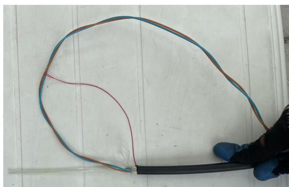
Coloque cinta aislante en el inicio del buffer de fibra óptica como se aprecia en la siguiente figura.
